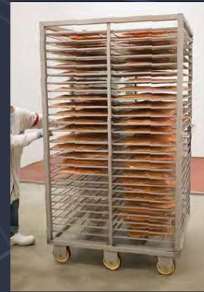
**SÉCHAGE VERTICAL****Châssis grande hauteur pour le séchage**
